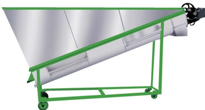
Fig. 3. Equipamento (esgotador de calor) para separar o suco da parte sólida da uva.
