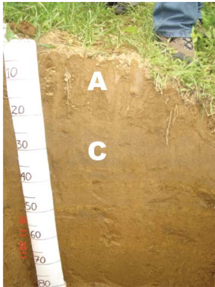
Figura 2. Perfil de Neossolo Flúvico (“terra de desmonte”) localizado no município de Morretes (PR). Foto: Andressa Kerecz Tavares.
