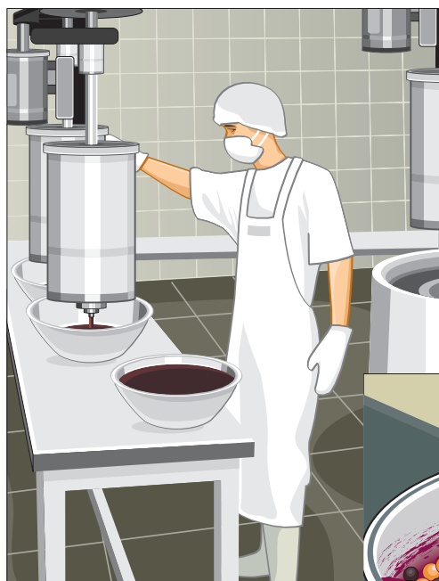
Fig. 7. Despulpamento mecânico de frutos de açaí.
